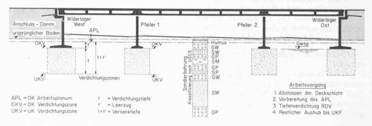
Bild 9. Tiefenverdichtung, Methode RDV, für die Gründung von vier Brückenfundamenten auf unregelmässig gelagertem Untergrund
