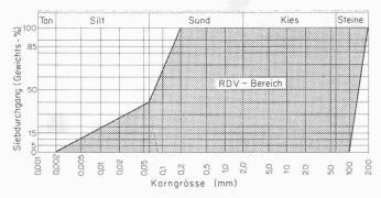
Bild 7. Anwendungsbereich für das Rütteldruckverfahren (RDV)
