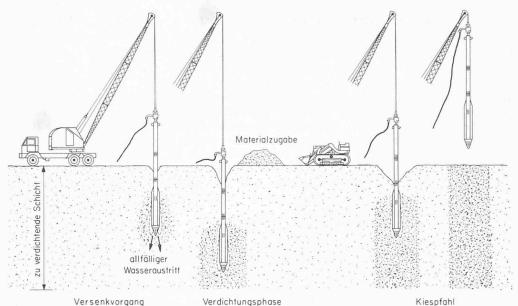
vorgang so oft wiederholt, bis zur vorgeschriebenen Fundamentkote ein zylinderförmig verdichteter Erdkörper entstanden ist. Die Umlagerung erfolgt spannungsfrei, der Erdkörper ist auch gegen Erosion weitgehend unempfindlich, und damit die Verdichtung eine dauernde. Infolge der Porenvolumenverminderung des Bodens entsteht an der Oberfläche ein Trichter (Bild 4), in welchen zum Ausgleich laufend Material zugegeben wird.
