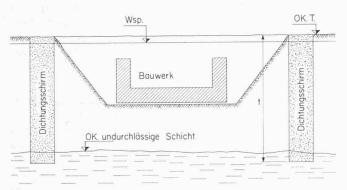
Bild 12. k-Wert-Reduktion beschränkt sich auf Dichtungsschirm, falls eine praktisch undurchlässige Schicht ansteht
