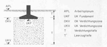
Bild 6. Vergrösserung der Verdichtungsfläche gegenüber Fundamentfläche
