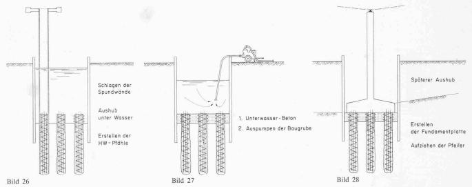
Bilder 26 bis 28. Bauphasen zur Erstellung eines Fundamentes in stark wasserführendem Baugrund (Schiffahrtsöffnungen im Seedamm von Melide)
