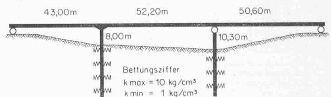
Bild 11. Statisches System der Autobahnbrücke im Grüeblichachen
