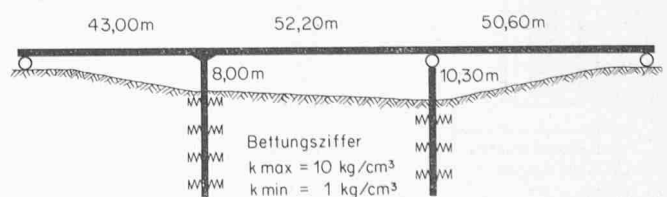
Bild 11. Statisches System der Autobahnbrücke im Grüeblichachen
