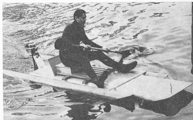
Bild 5. Motor- und Paddelboot, hergestellt mit Rundholz-Schalen
