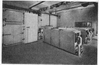
Beton-Frostanlage in der Empa
