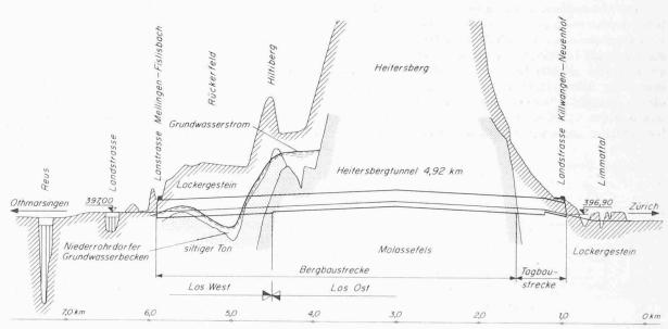
Längenprofil des Heitersbergtunnels. Höhenprofil zehnfach überhöht
