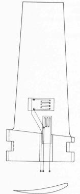
Bild 3. Anordnung der Dehnungsmessstreifen an der Leitschaufel. Verwendet wurden Streifen der Firma Hottinger Baldwin, Type 3/120 LP 11. Widerstand 121,2  $\pm$  0,25%, K – Faktor: 2,05  $\pm$  0,5%.
