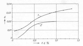
Bild 1. Logarithmisches Dämpfungsdekrement  $\delta$  der Schaufel der ersten Leitreihe in Abhängigkeit von der Dehnungsamplitude  $\varepsilon$  (Kurve 1). Als Vergleich wurde das Dekrement der reinen Werkstoffdämpfung eingetragen (Kurve 2)
