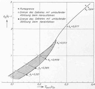
Bild 5. Druckerzeugung  $p_2/p_1$ -1 und Gebiet der umlaufenden Ablösung in Abhängigkeit von der relativen Schluckziffer  $c_{ax}/c_{S1}$  für verschiedene Drehzahlziffern  $k_u$ . Reynoldszahl Re=0.5 bis  $0.7\,10^\circ$
