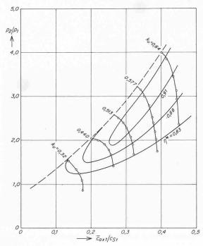
Bild 4. Druck-Förderkurven des Versuchsverdichters. Druckverhältnis  $p_2/p_1$  in Abhängigkeit von der relativen Schluckziffer  $\overline{c}_{ax1}/c_{S1}$  für verschiedene Drehzahlziffern  $k_u$ . Ausgezogene Kurven sind Linien gleichen Beschaufelungswirkungsgrades  $\eta^*$ , die gestrichelte Kurve gibt die Pumpgrenze an
