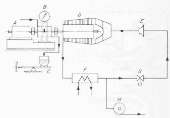
Bild 4. Versuchsordnung im Windkanal. Der Windkanal kann evakuiert oder aufgeladen werden; damit lässt sich ein Gebläse mit verschiedenen Reynoldszahlen prüfen. In Bild 4 ist nur das Evakuierungsgebläse eingezeichnet.
