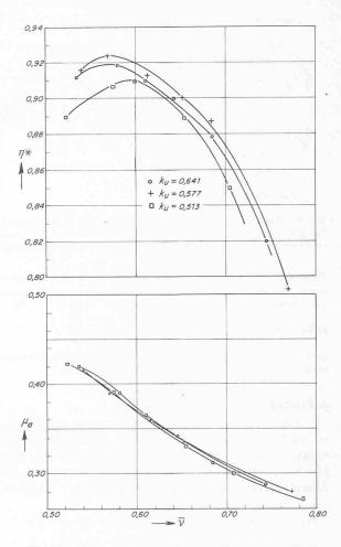
Bild 12. Messergebnisse mit der Schaufelwinkelkombination  $58^{\circ}/55^{\circ}$ . Arbeitswirkungsgrad  $\eta^*$  und Schaufelarbeitsziffer  $\mu_a$  in Abhängigkeit von der mittleren Geschwindigkeitsziffer  $\overline{\nu}$  für drei verschiedene relative Drehzahlziffern  $k_u$
