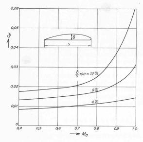
Bild 1. Widerstandsbeiwert  $c_w$  eines Tragflügelprofils in Funktion der Machzahl Ma. Als Parameter ist die relative Profildicke  $\delta/s$  aufgetragen. Man sieht, dass bei gleichem Wert  $c_w$  das Profil kleinerer Dicke  $\delta/s$  eine höhere Machzahl zulässt. So ist z. B. der Widerstandsbeiwert bei einer Schaufeldicke von 4% und Ma=0.98 gleich gross, wie bei Ma=0.54 und 8% Schaufeldicke.
