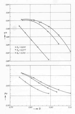
Bild 10. Messergebnisse mit der Schaufelwinkelkombination 65°/67°. Arbeitswirkungsgrad  $\eta^*$  und Schaufelarbeitsziffer  $\mu_a$  in Abhängigkeit von der mittleren Geschwindigkeitsziffer  $\overline{v}$  für drei verschiedene relative Drehzahlziffern  $k_u$
