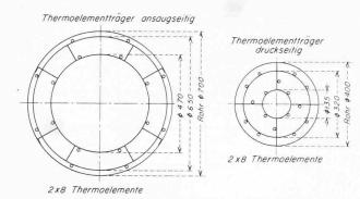
Bild 6. Anordnung der Temperaturmessung mit Thermoelementen am Eintritt (links) und Austritt (rechts) des Verdichters. Die Temperaturmessung erfolgte mit je  $2\pm 8$  Thermoelementen in Serieschaltung.
