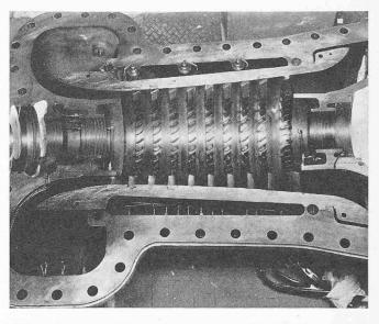
Bild 7. Versuchsverdichter mit abgedecktem Oberteil. Man sieht die vielen Messanschlüsse, welche zur genauen Abklärung der Druckerzeugung in den Zwischenstufen notwendig waren.
