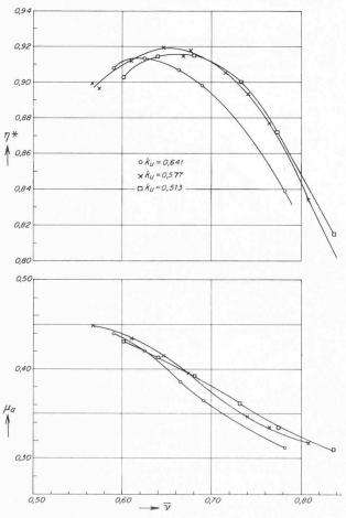
Bild 8. Messergebnisse mit der Schaufelwinkelkombination 65°/55°. Arbeitswirkungsgrad  $\eta^*$  und Schaufelarbeitsziffer  $\mu_a$  in Abhängigkeit von der mittleren Geschwindigkeitsziffer  $\overline{\nu}$  für drei verschiedene relative Drehzahlziffern  $k_u$ .
