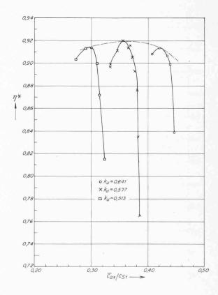
Bild 9. Arbeitswirkungsgrad  $\eta^*$  in Abhängigkeit von der relativen Schluckziffer  $\overline{c}_{ax}/c_{S1}$ , für die drei Fälle nach Bild 8
