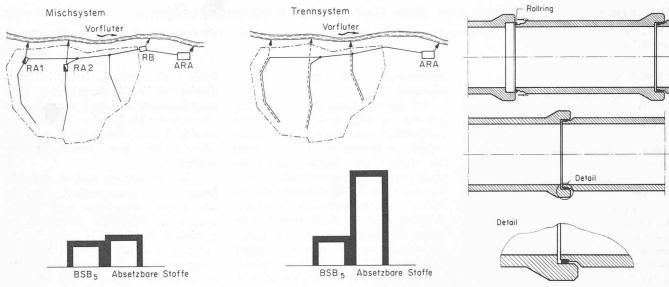
Bild 2. Schematische Darstellung der Vorfluterbelastung in bezug auf BSB5 und absetzbare Stoffe beim Trennsystem und beim Mischsystem
