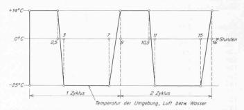
Bild 1. Frostdiagramm. Zyklus: drei Frostwechsel im Tag, nämlich: Frost  $5\frac{1}{2}$  h bei  $-25\,^{\circ}$ C, Auftauen  $2\frac{1}{2}$  h bei  $+14\,^{\circ}$ C.
