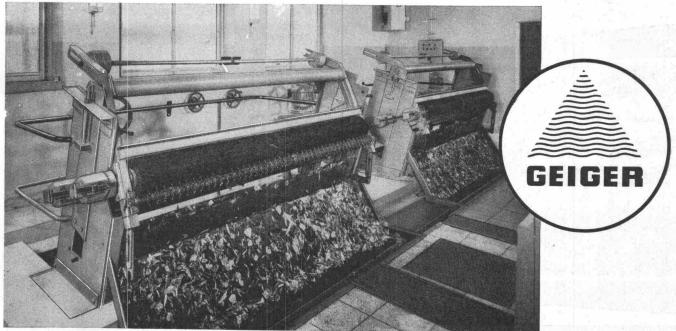
RECHEN- UND SIEBANLAGEN ZUR BRAUCHWASSERREINIGUNG
