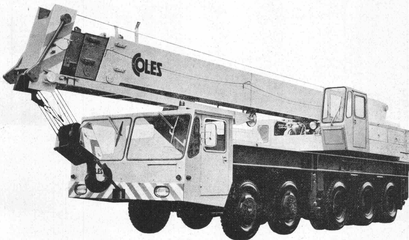
COLES L45 Autokran, Tragkraft 45 t, Hakenhöhe 53 m
