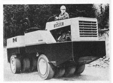
heiten sind durch eine Kupplung verbunden, die 70 ° Schwenken und 20 ° vertikales Pendeln zwischen den Einheiten erlaubt, um Bodenunebenheiten auszugleichen.
