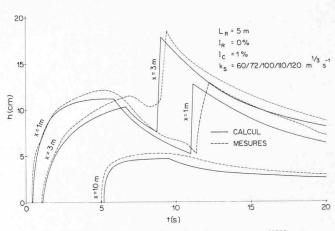
Fig. 11. Hauteurs d'eau en fonction du temps en différentes sections
