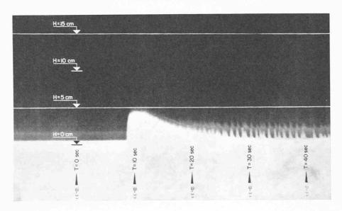
Fig. 8. Enregistrement limnigraphique du passage de «roll-waves»
