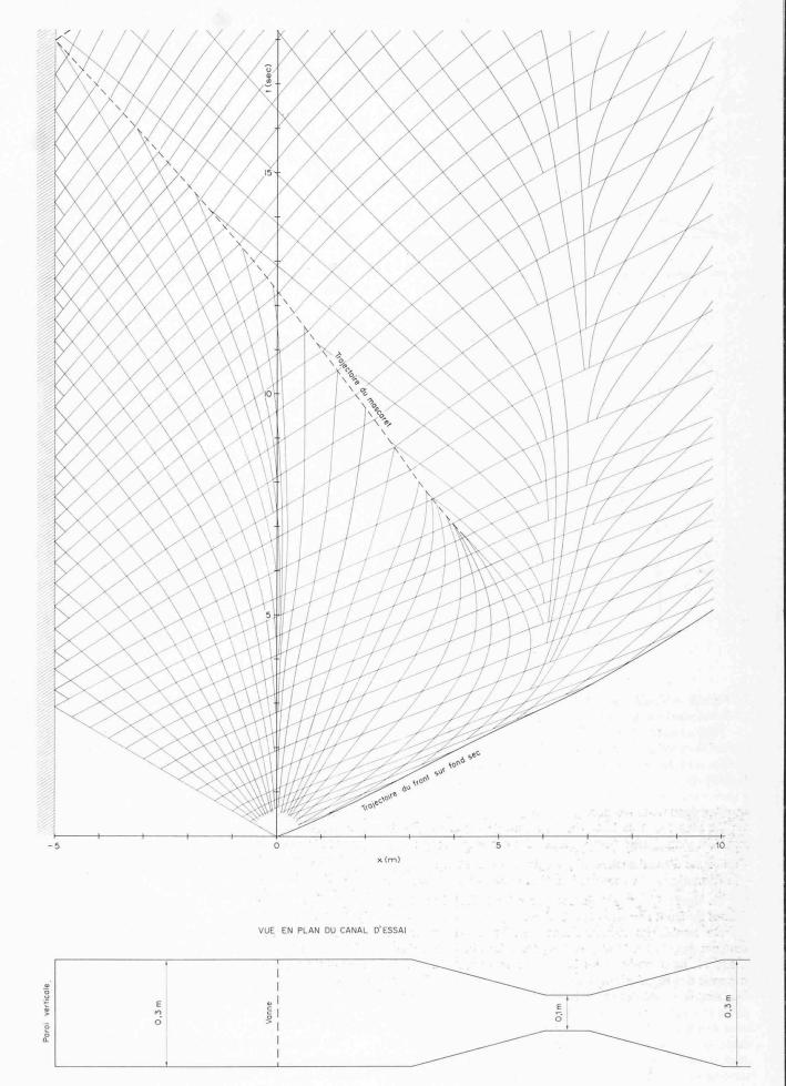
Fig. 9. Réseau des caractéristiques calculées dans le plan (x, t) et géométrie du «canal Venturi»
