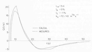
Fig. 6. Débit en fonction du temps en x = 10 m
