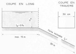
Fig. 1. Dimensions du canal d'essai
