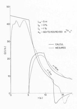
Fig. 12 (à gauche). Débits en fonction du temps en deux sections situées de part et d'autre du passage Venturi
