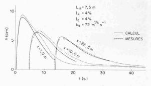
Fig. 3. Hauteurs d'eau en fonction du temps en différentes sections
