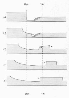
Fig. 13 (à droite). Evolution schématique de l'écoulement juste après la rupture
