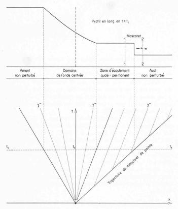
Fig. 6. Solution de Stoker
