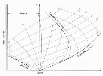
Fig. 3. Réseau des caractéristiques dans le plan x, t
