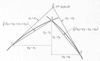
Bild 4. Schema der Berechnung eines allgemeinen Punktes 3 des Charakteristikennetzes ausgehend von den bekannten Punkten 1 und 2
