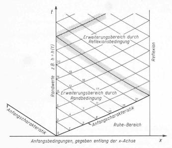
Bild 3. Schematische Darstellung der Bestimmung des Charakteristikennetzes und der dazu benötigten Anfangs- und Randwertangaben
