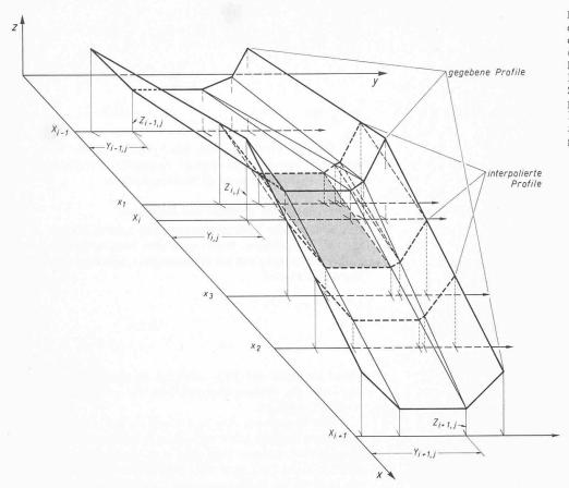
Bild 5. Erfassen der Geometrie eines Gerinnes. Zu beachten ist, dass die interpolierten Profile (vgl. Profil bei  $x_1$ ) mehr Seiten haben können als die gegebenen Profile und dass das berechnete Sohlengefälle zwischen den interpolierten Profilen (schattierte Fläche zwischen den Profilen bei  $x_1$  und  $x_3$ ) nicht demjenigen der gegebenen Geometrie entspricht
