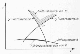
Bild 2. Abhängigkeits- und Einflussbereich eines Punktes des Charakteristikennetzes
