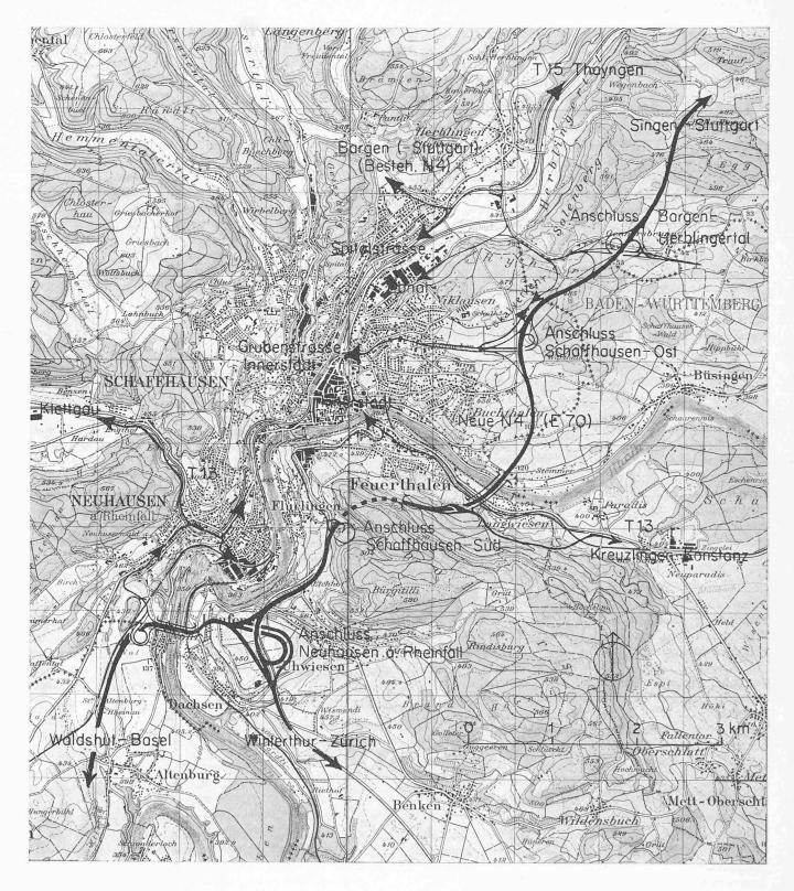
Bild 6. Projektskizze des Verfassers zu einer Ostumfahrung Schaffhausens durch eine «Neue N 4» Richtung Thayngen-Singen. Reproduktion der Landeskarte 1:50 000 im Ausgabemassstab mit Bewilligung der Eidg. Landestopographie vom 26.2.70.
