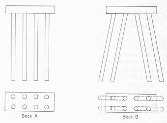
Bild 1. Form der Pfahlbocktypen A und B
