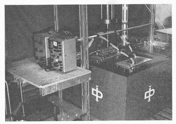
Bild 3. Einbau der Pfahlböcke samt Messanordnung im Behälter
