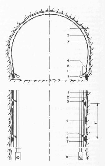
Bild 3. Anordnung der Vakuum-Leitungen im Tunnel. 1 Fels, 2 Spritzbeton/Gunit, 3 Sarnafil vor Erstellen des Vakuums, gehalten durch Überdruck oder Gerüst, 4 Vakuum-Sektorenleitung, 5 Verbindung Sektorenleitung-Hauptleitung, 6 Vakuum-Hauptleitung, 7 Gunit-Putzstreifen, 8 Vakuum-Pumpe, L Sektorenlänge
