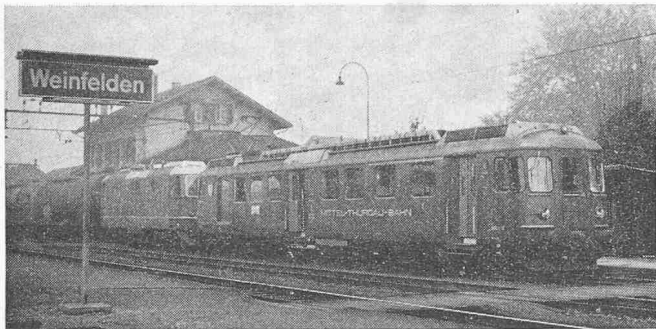
Bild 41. Triebwagen ABDe 4/4 12 der Mittel-Thurgau-Bahn (MThB) und Lokomotive Re 4/4 II 11141 der SBB in Vielfachsteuerung mit Ölzug
