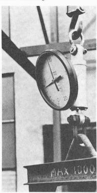
Belastungsanzeiger und Kranwaagen; sie werden zwischen Kranhaken bzw. Zugmittel so angebracht, dass an ihren Skalen bzw. Anzeigeteilen unmittelbar die tatsächliche Belastung mühelos abgelesen werden kann.
