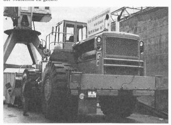
messungen und wegen den entsprechenden Leistungen auf. Das schwere Fahrgestell ist zweiteilig ausgeführt; der vordere Teil trägt die Grabeinrichtung, der hintere das Antriebsaggregat. Im Mittelpunkt zwischen den Achsen sind die zwei Hälften drehbar zusammengefügt; hier befindet sich der Drehpunkt
