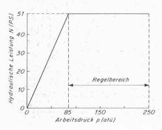
Links: Bild 5. Rückdruckverwertung; Leistungsschaubild mit selbstregelnder Pumpe
