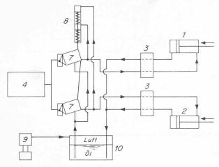
Bild 8. Zwei-Pumpen-Antrieb mit Summenregelung; Ölkreislauf bei zwei gleichzeitigen Bewegungen
