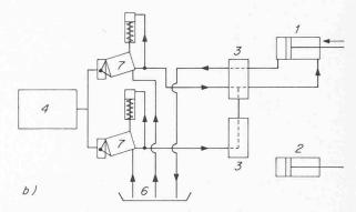
Bild 7. Zwei-Pumpen-Antrieb mit selbstregelnden Pumpen. a) Ölkreislauf bei zwei gleichzeitigen Bewegungen, b) Ölkreislauf bei automatisch wirksam werdender Doppelbeaufschlagung
