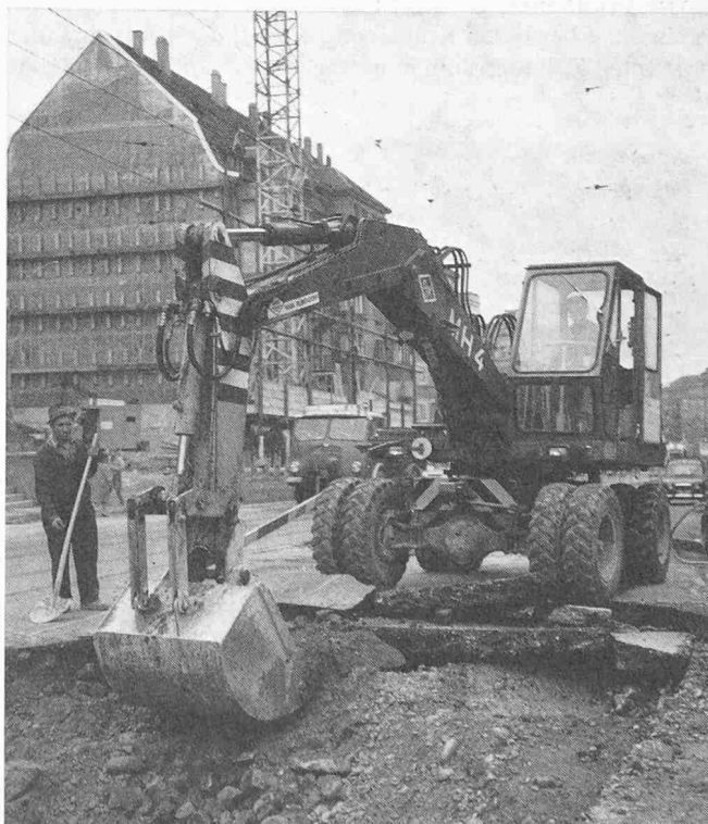
Hydraulik-Bagger MH 4 mit selbstregelnder Pumpe und Rückdruckverwertung
