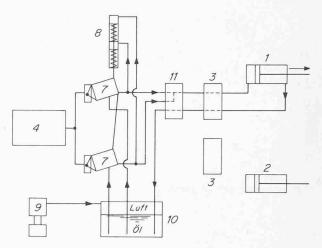
Bild 10. Zwei-Pumpen-Antrieb mit Summenregelung und geschalteter Doppelbeaufschlagung
