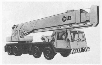
trägt 7,62 m. Die Tragkraft mit abgestütztem Wagen erreicht bei 3,66 m Radius 45 t und die grösste Auslegerlänge mit Spitzenausleger 70,10 m. Der Kran kann sowohl mit Frontwie auch mit Turmausleger eingesetzt werden, wobei die gleichen Auslegerelemente verwendet werden. Als Turmkran erreicht dieses Gerät eine maximale Höhe von 56,70 m. Die am Boden montierten Elemente des Auslegers, ob Turm- oder Frontausleger, werden durch die Maschine selbst hochgezogen.
