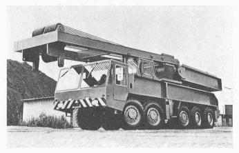
Bild 2. Schwerer Autokran mit vollhydraulischem Teleskopauslege ibis 28 m Länge; Tragfähigkeit 34 t.
