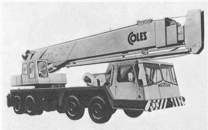
Bild 2. Schwerer Autokran mit vollhydraulischem Teleskopausleger bei 28 m Länge; Tragfähigkeit 34 t.
