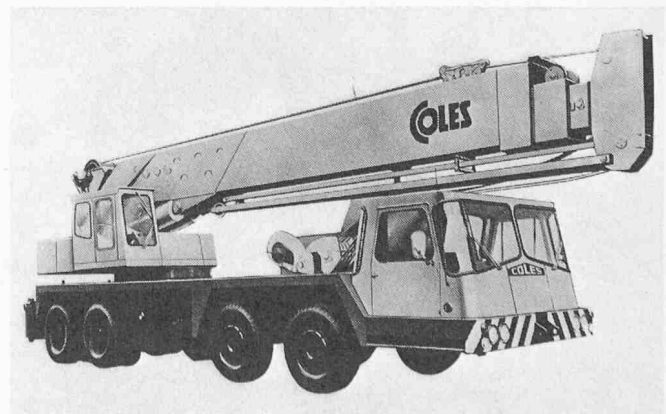
Bild 2. Schwerer Autokran mit vollhydraulischem Teleskopausleger bis 28 m Länge; Tragfähigkeit 34 t.
