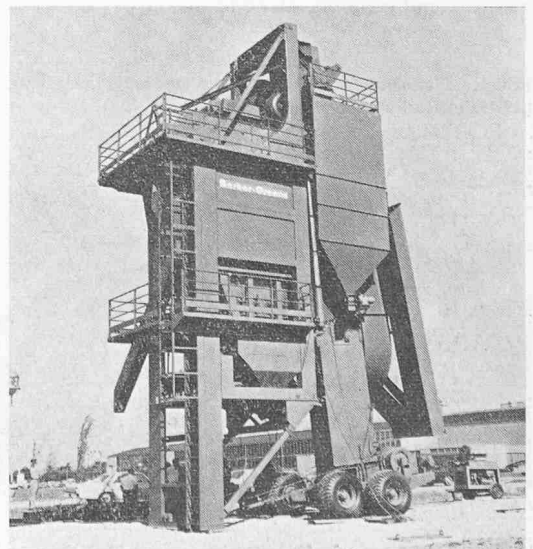
Bild 3. Die fertig aufgestellte Mischanlage «Batchpac» mit einer Leistung von 500 t/h. Das Fahrwerk und die Diagonalstreben müssen noch entfernt werden
