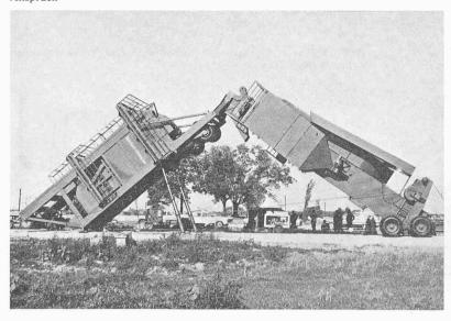
Bild 3. Die fertig aufgestellte Mischanlage «Batchpac» mit einer Leistung von 500 t/h. Das Fahrwerk und die Diagonalstreben müssen noch entfernt werden
