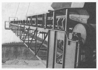
Bild 15. Schwenkbares, frei ausragendes Förderband der Deponieanlage
