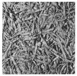
Struktur einer unbeschichteten Heraklith-Leichtbauplatte
