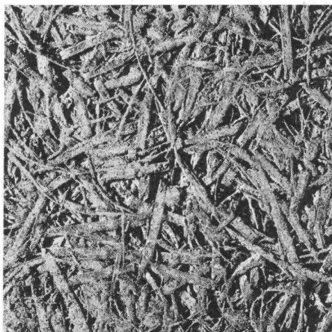
Struktur einer unbeschichteten Heraklith-Leichtbauplatte
