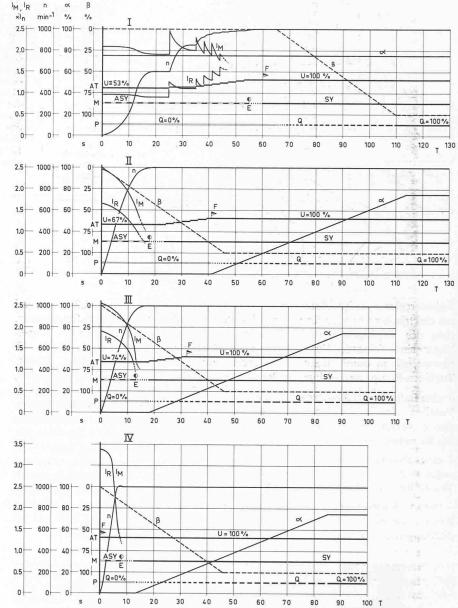
Bild 13. Anfahrdiagramme bei Pumpenbetrieb mit wassergefülltem Laufrad
