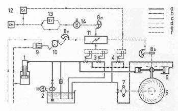
Bild 10. Prinzipschema des Leitradantriebes für die Umkehr-Pumpen-Turbinen nach Bild 8
