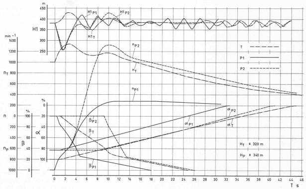
Bild 16. Entlastungsversuche mit einer umsteuerbaren Gruppe, die einmal als Pumpe, ein zweites Mal als Turbine arbeitete
