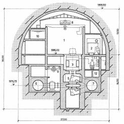
Bild 6. Zentralenquerschnitt 1:400 mit Maschinengruppen «Isogyre» nach Variante C, vertikalachsige Anordnung, 45 MVA
