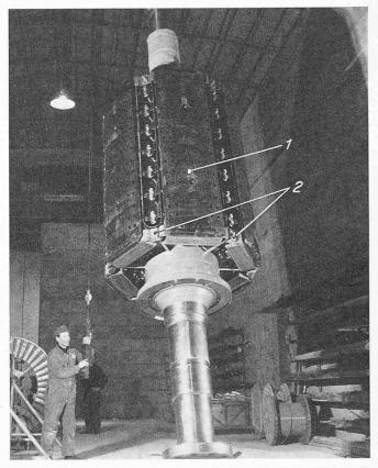
Bild 12. Rotor des Motor-Generators für 45 WVA, 1000 U/min 1 massiver Pol
