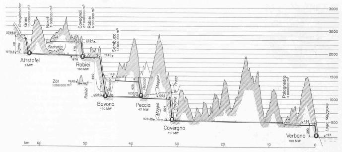
Bild 1b. Längenprofil der Maggia-Kraftwerke, Längen 1:300 000, Höhen 1:3000
