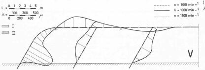
Bild 15. Schwingungen des Niederdruck-Sammelrohres und der Rohrstutzen bei Turbinenbetrieb der Gruppe 1 vor dem Betonieren
