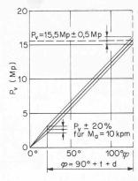
Bild 3a. Streubereich der Vorspannkraft  $P_v$  beim Anziehen nach der Drehmomenten-Methode (Schraube wie bei Bild 1)
