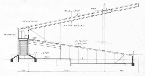
Bild 3. Tribünen-Querschnitt, 1:300
