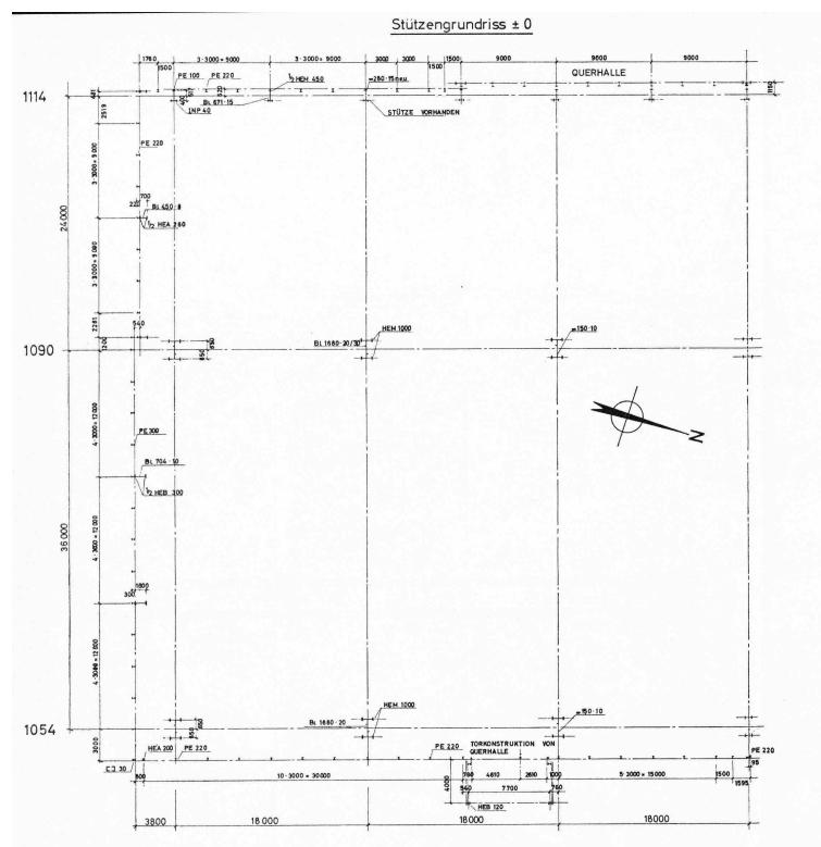
Bild 6. Gesamtübersicht der Stahlkonstruktion für die Hallen 9 und 10, 1:400. Stützengrundriss, Schnitte und Ansichten auf der Rückseite
