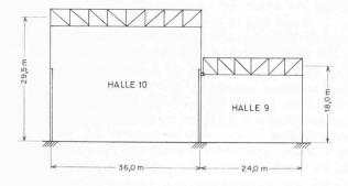
Bild 1. Schema des statischen Systems im Querschnitt
