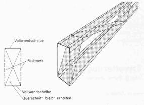
Bild 4. Aufbau des Torsionsträgers
