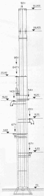
Bild 15. Stütze an der Achse 1090, mit maximalen Belastungen durch Dach und Kranbahnen 1:200
