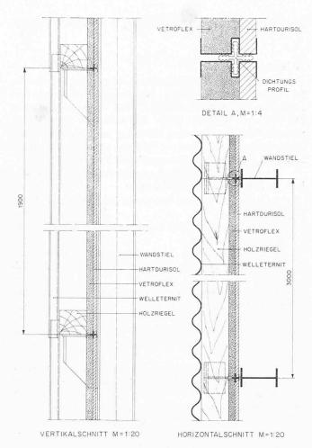
Bild 23. Vertikalschnitt (links) und Horizontalschnitt (rechts) durch eine Aussenwand mit Abdichtungsdetail der Plattenstösse
