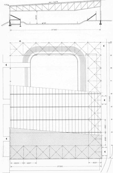
Bild 2. Eisstadion-Überdachung in La Chaux-de-Fonds, Querschnitt und Grundriss 1:600
