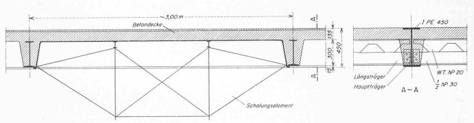
Bild 1. Deckenschnitte. Im mittleren Feld ist die Schalung miteingezeichnet
