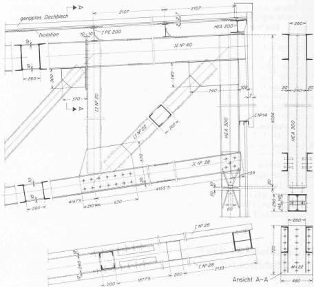
Bild 4. Einzelheiten der Binderkonstruktion
