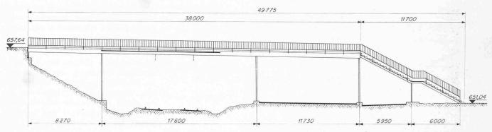
Bild 5. Der Fussgängersteg über die SBB in St. Gallen-Bruggen 1:300
