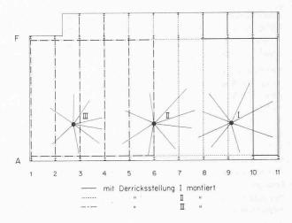
Bild 5. Montageeinrichtung und Derrickstellungen bei den drei Etappen
