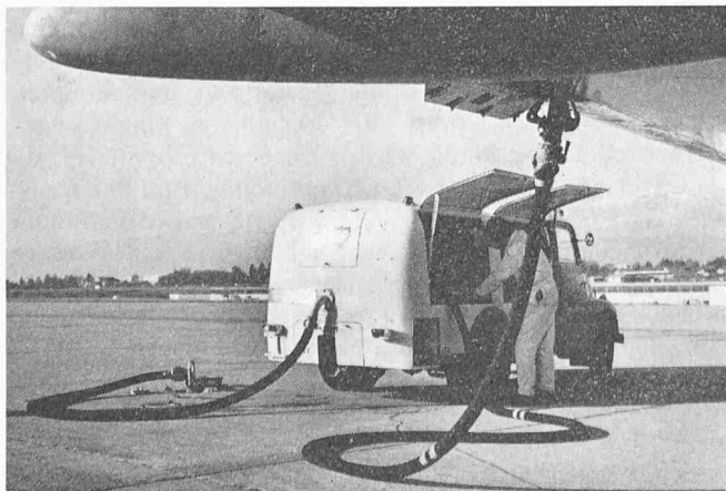
Bild 2. Über ein Austeilmfahrzeug wird vom unterirdischen Betankungssystem der Brennstoffbehälter eines Flugzeuges gefüllt
