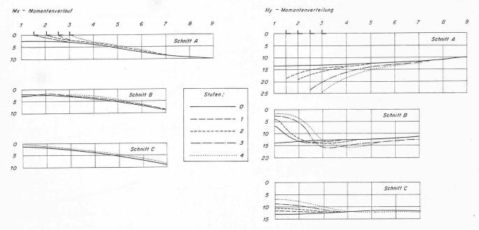
Bild 8. Gemessene Biegemomente [mt/m] der Versuchsserie III (Aussparung in Gurtstreifenmitte, «quer»)
