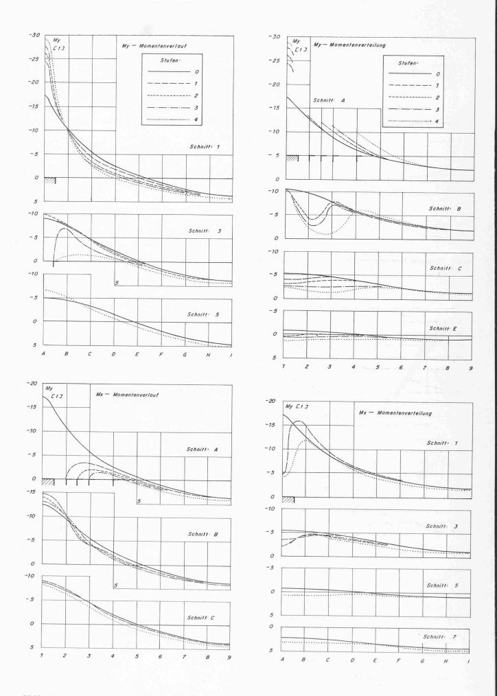
Bild 7. Gemessene Biegemomente [mt/m] der Versuchsserie II (Aussparungen im Stützenbereich)
