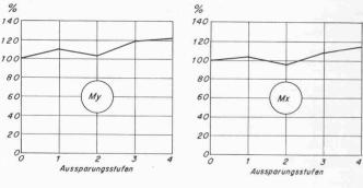
Bild 13. Auswertung der Versuchsserie IV: Prozentuale Veränderung der Momenten-Spitzenwerte bei sukzessiver Vergrösserung der Aussparung
