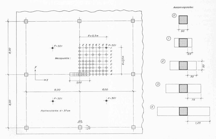
Bild 3. Abmessungen, Belastungsbild, Anordnung der Messpunkte und Aussparungsstufen bei Versuchsserie II. Belastungsmassstab 1 t = 1 kg
