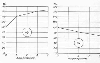
Bild 12. Auswertung der Versuchsserie III: Prozentuale Veränderung der Momentenspitzenwerte bei sukzessiver Vergrösserung der Aussparung
