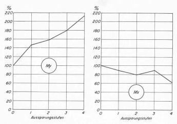
Bild 10. Auswertung der Versuchsserie I: Prozentuale Veränderung der Momentenspitzenwerte bei sukzessiver Vergrösserung der Aussparung
