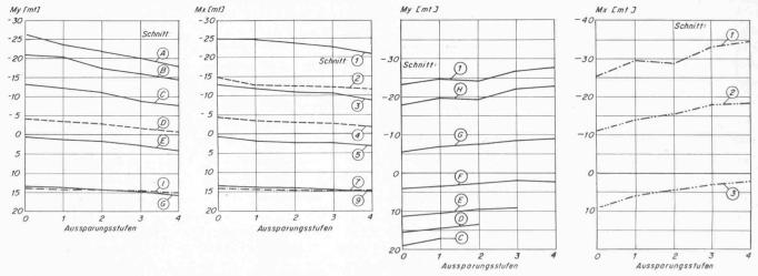
Bild 15. Auswertung der Versuchsserie II: Veränderung der Momenten-Integralwerte bei sukzessiver Vergrösserung der Aussparung
