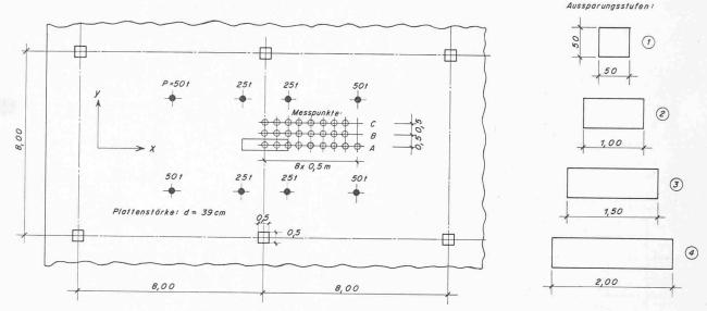
Bild 4. Abmessungen, Belastungsbild, Anordnung der Messpunkte und Aussparungsstufen bei Versuchsserie III Belastungsmassstab  $1\,\mathrm{t}=1\,\mathrm{kg}$
