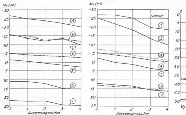
Bild 14. Auswertung der Versuchsserie I: Veränderung der Momenten-Integralwerte bei sukzessiver Vergrösserung der Aussparung
