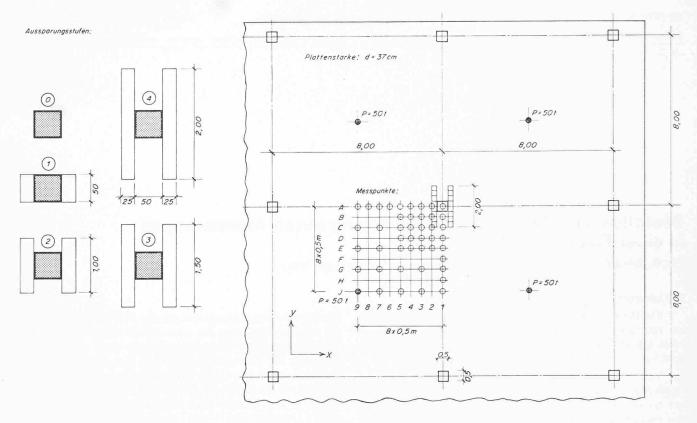
Bild 2. Abmessungen, Belastungsbild, Anordnung der Messpunkte und Aussparungsstufen bei Versuchsserie I. Belastungsmassstab 1 t = 1 kg
