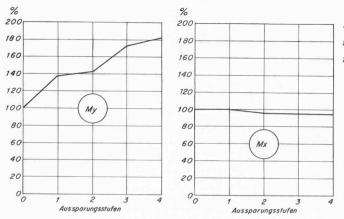
Bild 11. Auswertung der Versuchsserie II: Prozentuale Veränderung der Momentenspitzenwerte bei sukzessiver Vergrösserung der Aussparung
