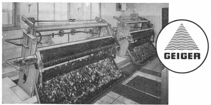
RECHEN- UND SIEBANLAGEN ZUR BRAUCHWASSERREINIGUNG Geiger-Feinrechen mit maschineller Reinigung haben sich seit Jahrzehnten zur Zurückhaltung von feinen Sperrstoffen aus Wasser und Abwasser, insbesondere von großen, stoßartig ankommenden Mengen von Laub, Heu und dergleichen, überall im harten Dauerbetrieb bewährt ■ Das Bild zeigt die Abwurfseite des Feinrechen in einem Kraftwerk bei starkem Laubfall.
