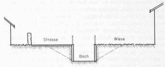
Bild 2. Das ungefähre Querprofil zu Bild 1 mit Eintragung der in der freien Landschaft anwendbaren Böschungen. Im vorliegenden Fall hätten solche die Strasse und Vorgärten verunmöglicht bzw. stark geschmälert
