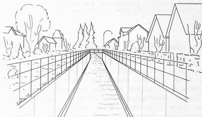
Bild 1. Skizze einer von Naturschutzverfechtern kritisierten Bachkorrektion in einem Wohngebiet. Ohne Seitenmauern hätten sowohl die Zufahrt zu den Gebäuden und möglicherweise die Vorgärten verschwinden müssen. Solche Korrekturen sind in Ortschaften von Fall zu Fall unumgänglich
