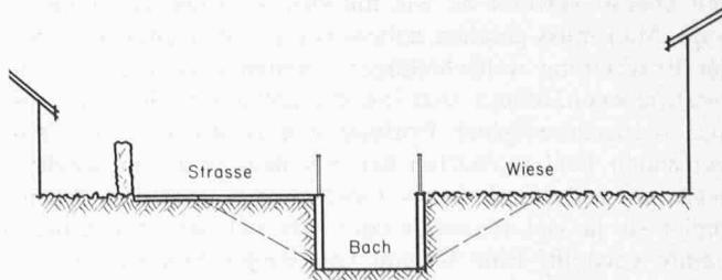
Bild 2. Das ungefähre Querprofil zu Bild 1 mit Eintragung der in der freien Landschaft anwendbaren Böschungen. Im vorliegenden Fall hätten solche die Strasse und Vorgärten verunmöglich bzw. stark geschmälert
