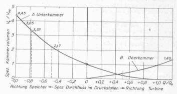
Bild 2. Vergrösserung des Kammervolumens bei einem idealisierten Kammerwasserschloss:
