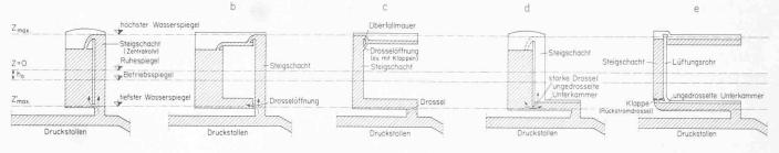
Bild 3a. Differentialwasserschloss nach Johnson
