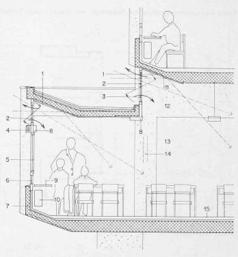
Schnitt 1:60 durch Klassenzimmer. Bezeichnungen: 1 Plafond en biais, favorisant l'évacuation de l'air vicié, 2 verre isolant anti-solaire, 3 fenêtre pivotante de ventilation, 4 stores à lamelles, 5 fenêtres ouvrantes, 6 vitrage fixe, 7 béton apparant, isolation liège, 8 éclairage, 9 tablette de travail, 10 radiateur, 11 surface blanche réfléchissante, 12 structure portante en béton armé, 13 éléments de remplissage démontables, 14 installations, 15 revêtement de sol plastic
