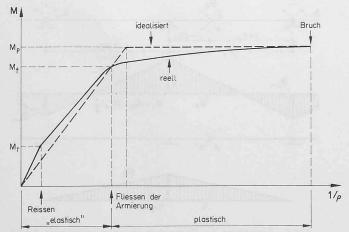
Bild 1. Momenten-Krümmungs-Diagramm eines Stahlbetonbalkens
