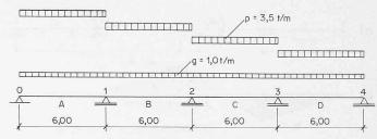
Bild 6. Durchlaufträger über 4 gleiche Felder
