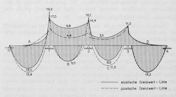
Bild 12. Elastische und plastische Momenten-Grenzwertlinien des untersuchten Durchlaufträgers
