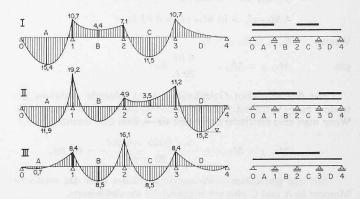
Bild 7. Elastische Momenten-Diagramme für verschiedene Lastfälle
