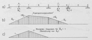
Bild 8. Berechnung des plastischen Gelenkwinkels für den Lastfall I
