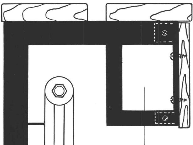
Sitzbank-Konsole mit Radiatorenbefestigung und Kabelkanalträger.
