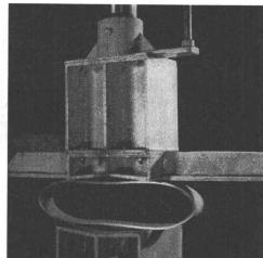
Duktile Gußrohre sind verformbar, bruchfest und korrosionsbeständig
