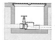
Rückstaudoppelverschluss TRIPLEX für durchgehende Leitungen
