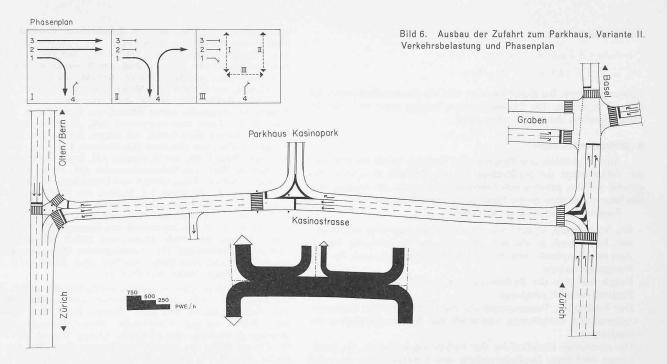
allgemein anerkannten Grundsätzen ist es bei diesen Belastungsverhältnissen angebracht, den Knotenpunkt mit Lichtsignalen zu regeln. Wie nachgewiesen werden kann, ist die Verkehrsregelung mit Lichtsignalen die leistungsfähigste Verkehrsregelung von entsprechend ausgebauten Knotenpunkten auf gleicher Ebene.
