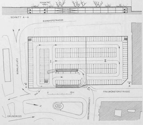
Bild 3. Schematischer Grundriss und Schnitt der Stadthaus-Anlage
