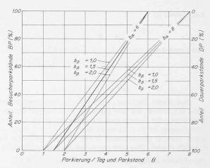
Bild 3. Anteil der Besucherparkstände (bzw. Dauerparkstände) in Abhängigkeit der Durchschnittsbelegung
