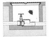
Rückstaudoppelverschluss TRIPLEX für durchgehende Leitungen
