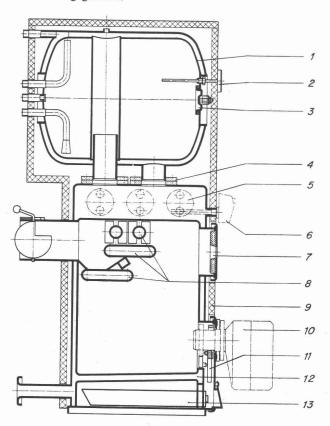
Bild 1. Schnitt durch den Idag-SB-Kessel
