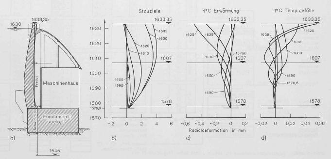
Bild 1. Horizontale Radialformationen im Hauptschnitt der Bogenstaumauer Ova Spin (a) für verschiedene Stauziele (b) bzw. Einheitstemperaturänderungen und -gefälle auf verschiedenen Mauerhöhen (c und d) auf Grund eines sechsschnittigen radialen Lastausgleichs
