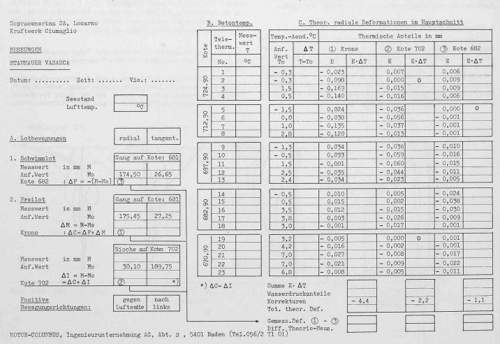
Bild 5. Kombiniertes Mess- und Auswertungsformular für die horizontalen Deformationen der drei Lotmesspunkte im Hauptschnitt der Bogenstaumauer Vasasca; der rechte Teil des Formulars dient der Nachrechnung der Radialdeformationen
