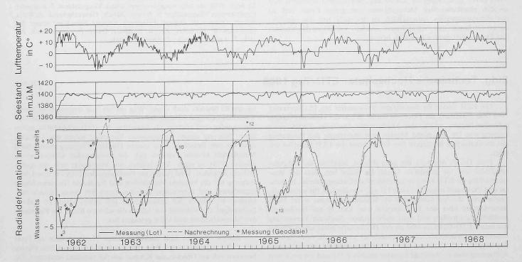
Bild 6. Gemessene und nachgerechnete horizontale Radialdeformationen des Kronenscheitels der Bogenstaumauer Sufers mit Ganglinie der Lufttemperatur und des Seestandes
